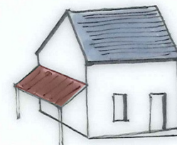
Intégration de panneaux thermiques sur la couverture d'un appentis
