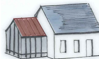
Intégration de panneaux thermiques sur la couverture d'une véranda ou d'une verrière
