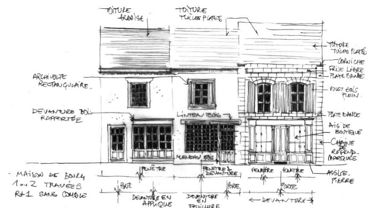
Maisons de bourg avec devantures commerciales en applique et en feuillure. Les éléments menuisés viennent habiller les façades, largement creusées dans leur rez-de-chaussée pour laisser se déployer la devanture.
