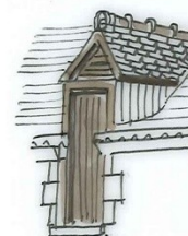
Lucarne pendante à deux pans, fronton bois et jouées en hardane bois
