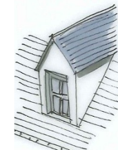
Lucarne dite jacobine à deux pentes (maçonnée et enduite) dite
