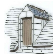
Lucarne engagée à fronton triangulaire en pierre de taille et deux pentes
