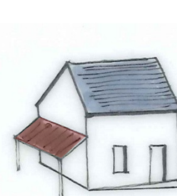
Intégration de panneaux thermiques ou photovoltaïques sur la couverture d'un appentis
