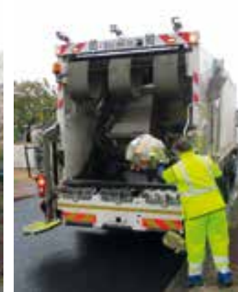
L'arrière d'un camion de collecte à deux compartiments : le gauche pour les bacs/sacs-poubelle noirs et le droit pour les bacs/sacs jaunes.
