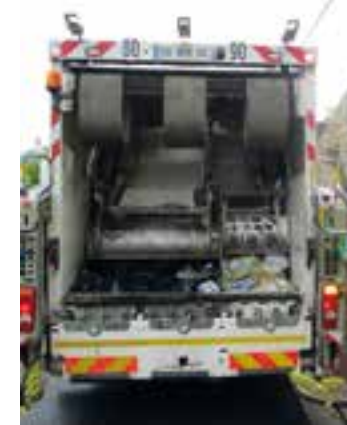
L'arrière d'un camion de collecte à deux compartiments : le gauche pour les bacs/sacs-poubelle noirs et le droit pour les bacs/sacs jaunes.
